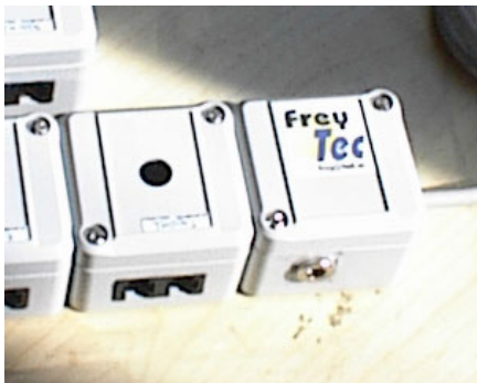
links: Messunit; rechts: RS485 Konverter
